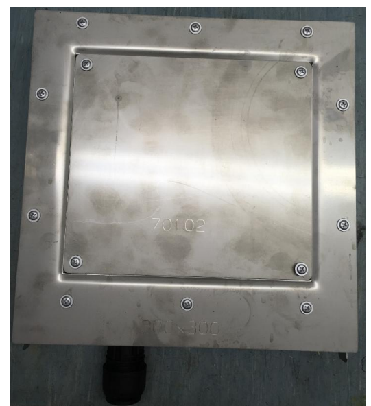
Fig.2. Provstycket med luckan stängt och med en monterade anslutningstyck för skyddsror
